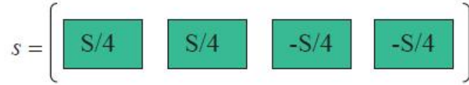
Figura 3.9: Estrutura do símbolo de treinamento no método B do Algoritmo de Minn e Bhargava.
