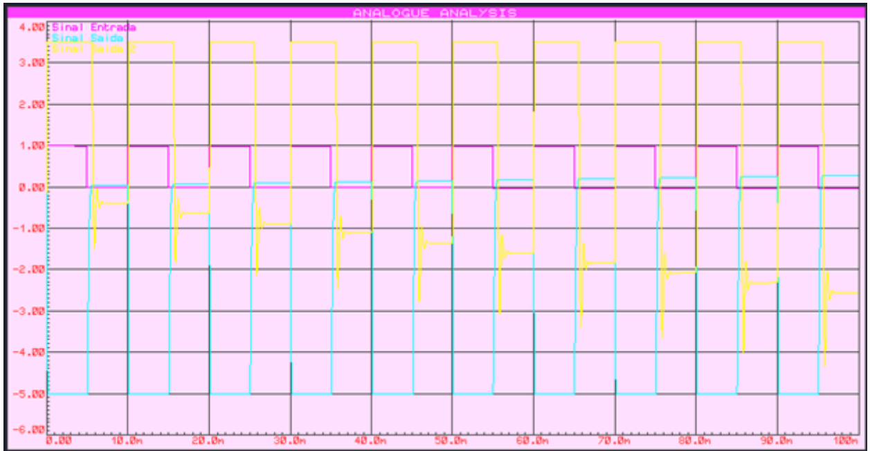
Figura 36: Sinal de entrada de 1V e saída do filtro passa-baixa de 4ª ordem com amplificador operacional LM324.
