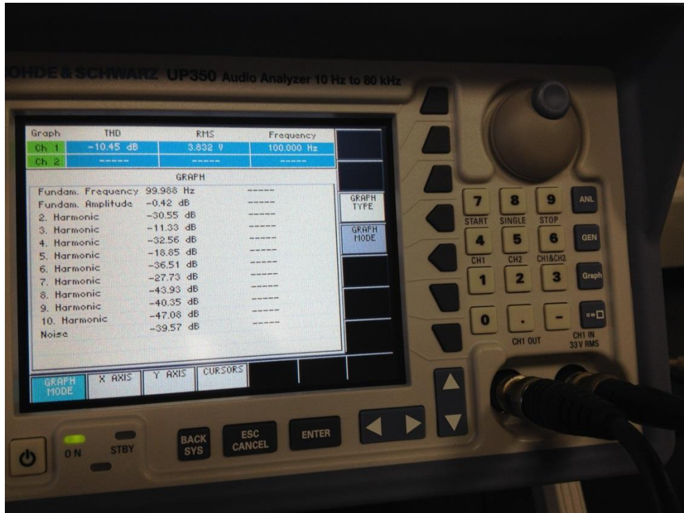
Figura 43: Foto retirada do analisador de áudio coletando a THD para a frequência de 100Hz.
