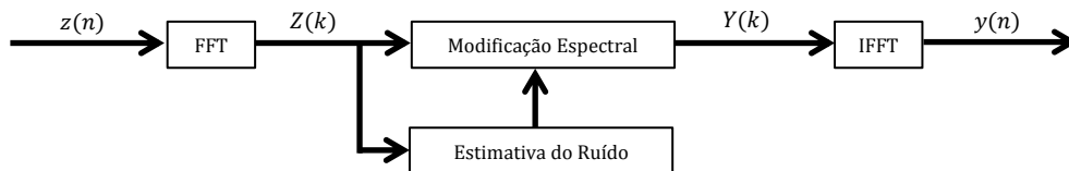
Figura 3-8 – Subtração espectral, sendo z(n) um bloco do sinal de entrada, Z(k) a transformada rápida de Fourier de z(n) , Y(k) o espectro do sinal reconstruído e y(n) a transformada Inversa.
