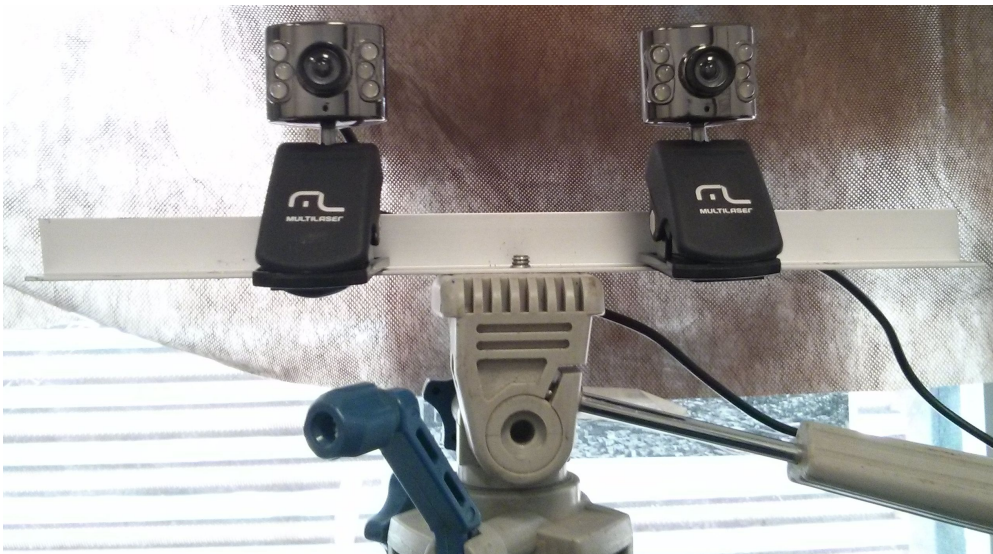
Figura 8.2: Webcams utilizadas para captura de imagens em estéreo. Fonte: o autor.
