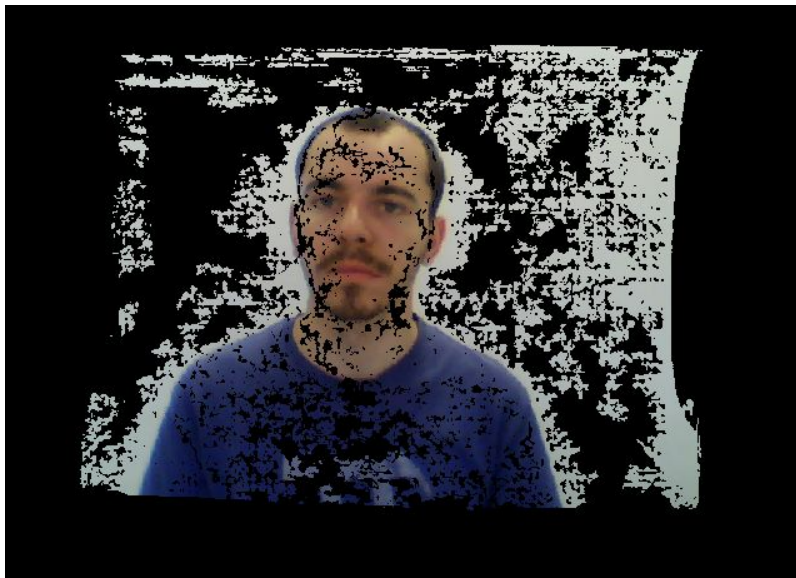
Figura 9.13: Visualizador da nuvem de pontos em “tempo real”. O tempo de exibição entre nuvens de pontos foi entre um a quatro segundos. Fonte: o autor.
