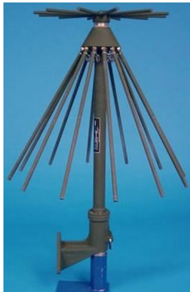
Figura 25- Antena discone construída com materiais alternativos, (Extraído de http://forums.radioreference.com/ em 05/12/2015)
