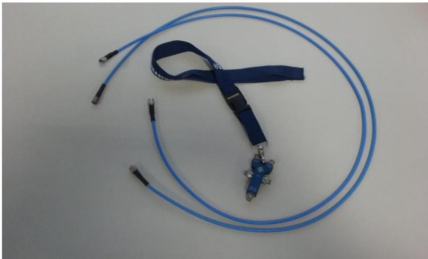
Figura 5.9 – Kit de calibração R&S e cabos com conectores SMA.
