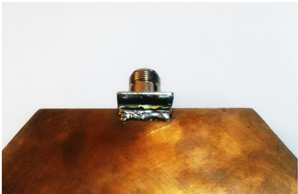
Figura 26 - Adaptação do conector ao plano terra
