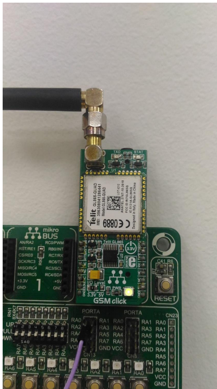
Figura 28: Imagem aproximada do módulo Telit GL865 QUAD conectada à placa.
