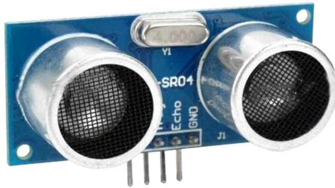
Figura 7: Representação do sensor ultrassônico HC-SR04.
