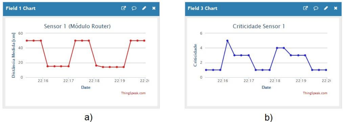
Figura 29: Gráfico da distância do sensor 1 ao líquido em função do tempo na figura a) e da sua criticidade calculada na figura b) para o terceiro teste.
