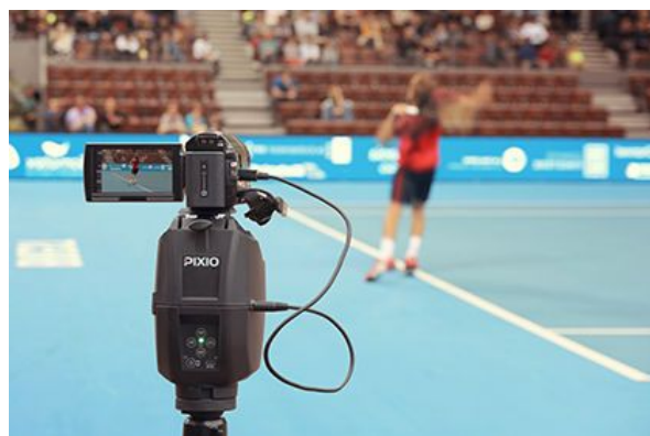
(b) Suporte que movimenta a câmera automaticamente
