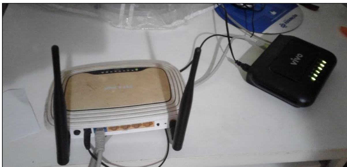
Figura 12: Configuração da rede sem cabo irradiante e com duas antenas no roteador
