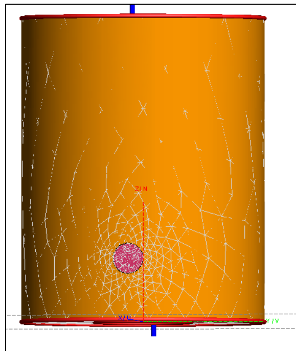
Figura 52: Fenda modelada no cabo
