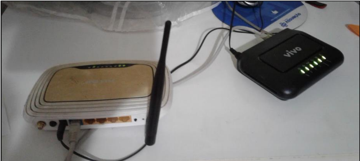
Figura 13: Configuração da rede sem cabo irradiante e com uma antena no roteador
