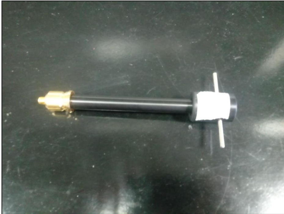
Figura 62: Antena dipolo meia onda
