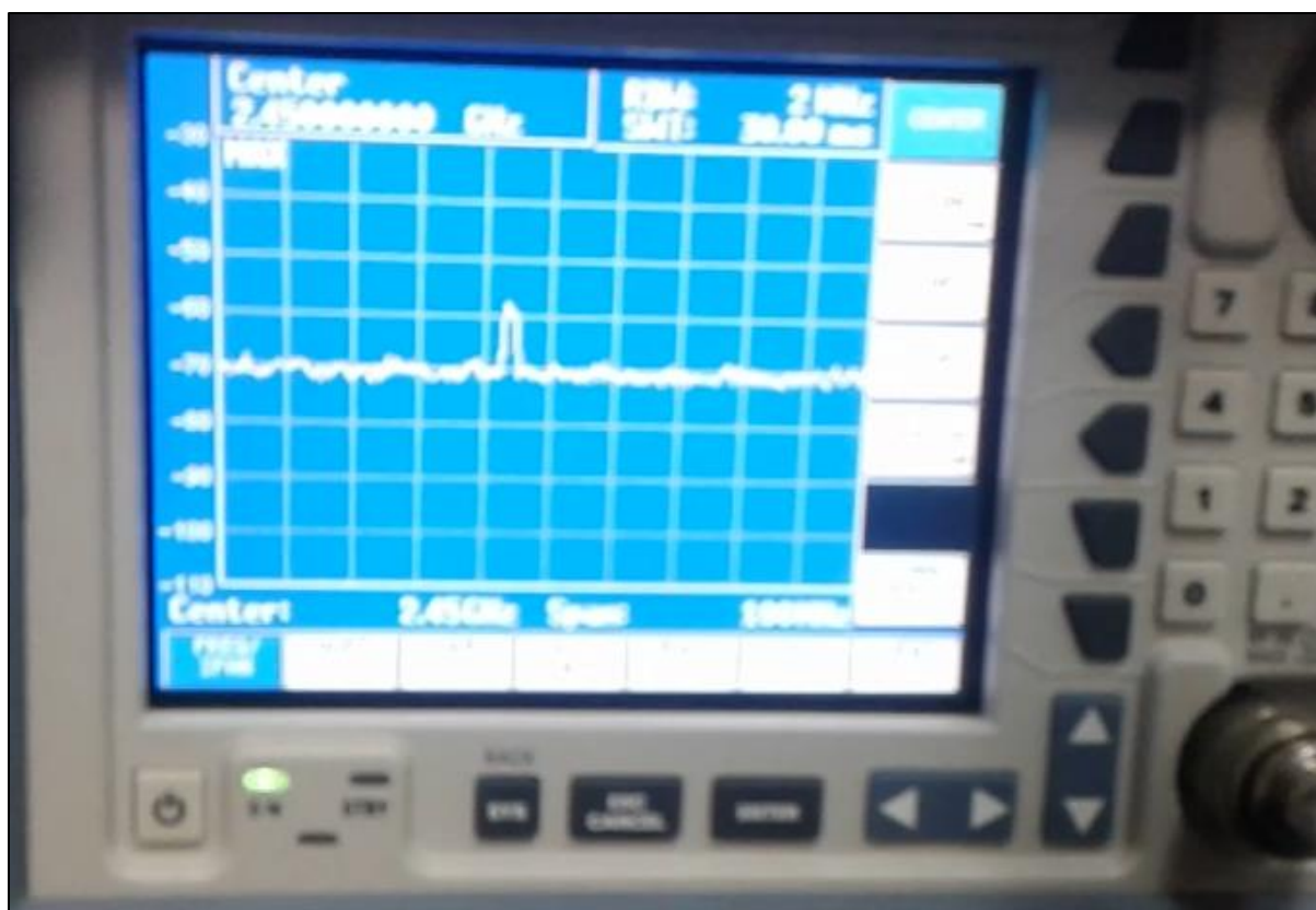
Figura 19: Gráfico do analisador de redes (sem a presença do cabo irradiante)
