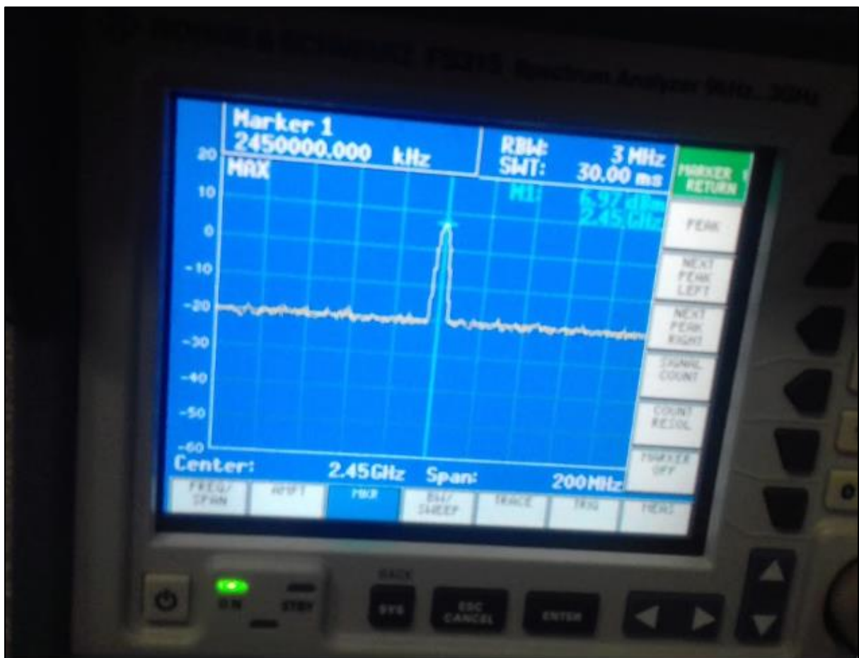
Figura 41: Configuração e resultado no analisador de espectro
