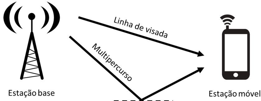
Figura 4.1 – Ilustração de um canal de multipercurso com dois feixes.
