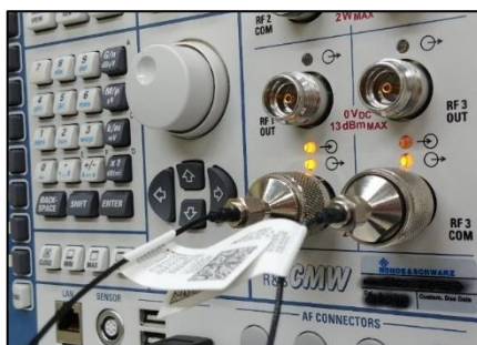
Figura 8.5 – Saídas RF do CMW500 para o esquema MIMO.
