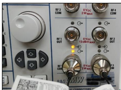
Figura 8.2 – Saída RF do CMW500 para o esquema SISO.
