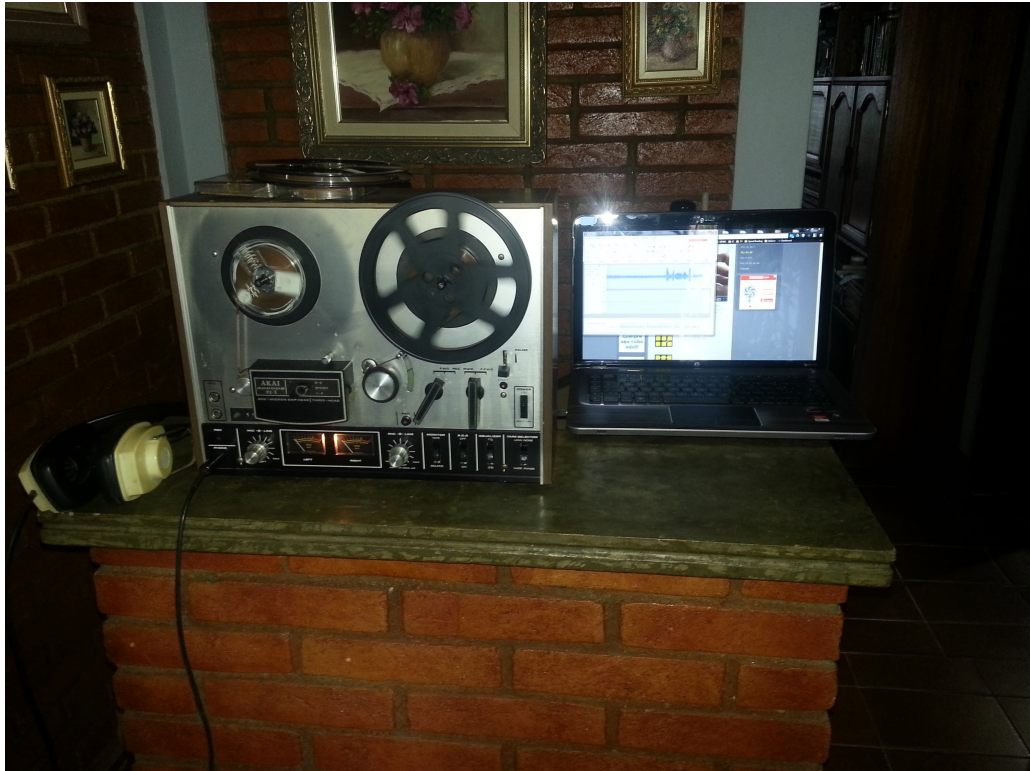
Figura 4 – Sistema de digitalização das fitas de rolo.
