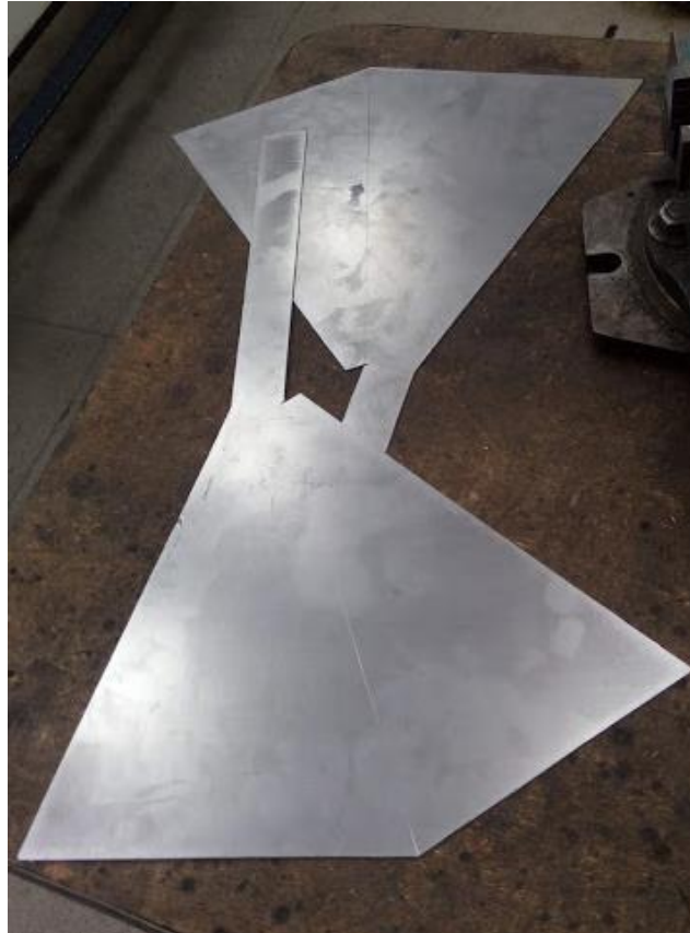
Figura 3. 23. Chapa de aço carbono após o corte.
