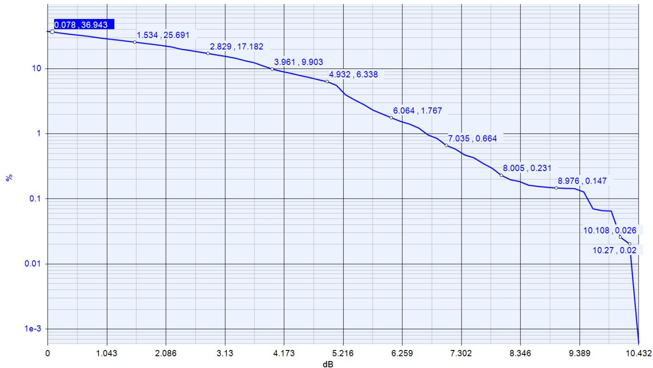
Figura 23: Porcentagem do sinal vs nível potência de transmissão em relação à média para a FBMC.
