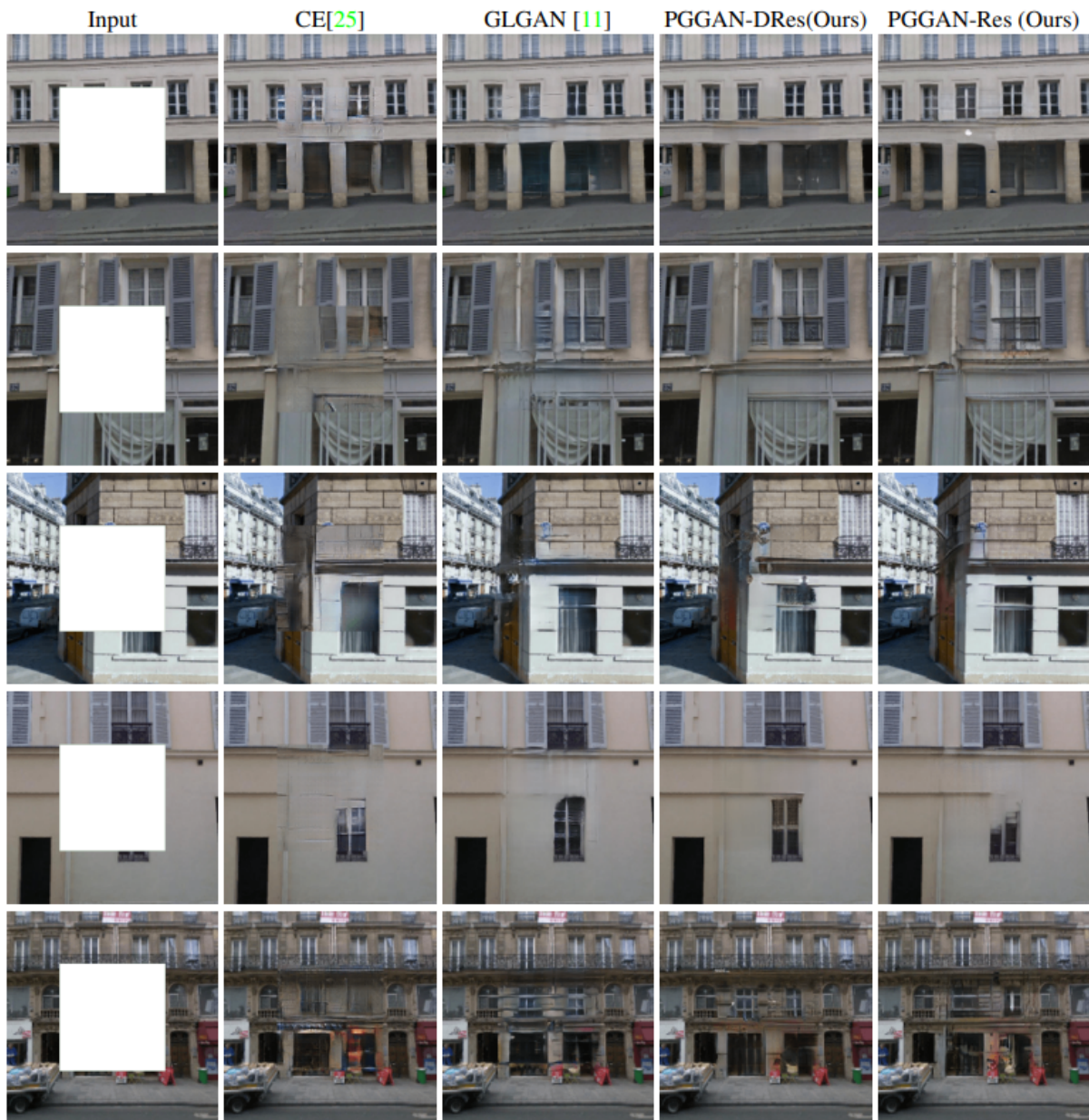
Figura 4 - Na primeira coluna estão as imagens de entrada com região faltante. Na segunda coluna em diante são mostrados resultados para os seguintes métodos, respectivamente: codificadores de contexto, Globally and Locally Consistent Image Completion , PGGAN com ResNet utilizando convoluções dilatadas (PGGAN-DRes) e PGGAN com ResNet (PGGAN-Res) [16] .
